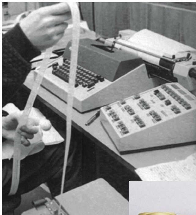
Rys. 8. Perforator taśmy papierowej typu Optima z maszyną do pisania programów w języku Algol
