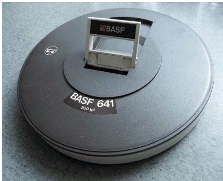
Rys. 25. Oryginalny wymienny dysk MERY 400 o pojemności 1.5 – 2 MB i średnicy 38 cm
