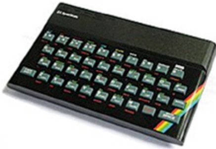
Rys. 18. Mikrokomputer ZX Spectrum (64 kB, 8-bitowy), podłączany do telewizora 6
